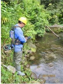
⇒ Calidad de aguas continentales y marinas, con multiparámetros, lo que nos permite realizar mediciones en la superficie hasta los 30 m de profundidad.
